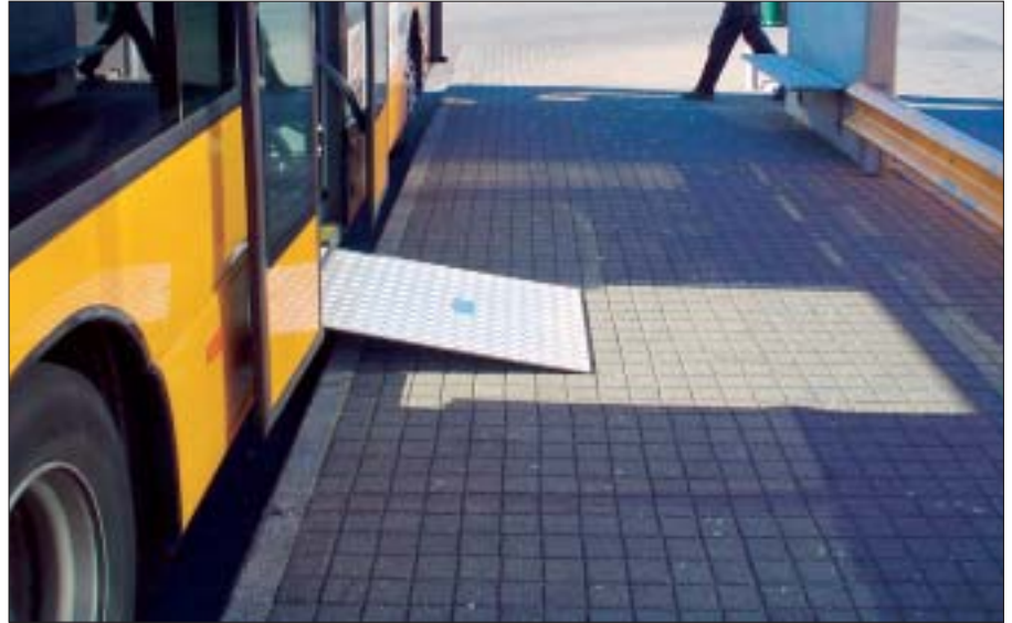
Útfellanlegur rampur, eins og sést á þessari mynd, og hjólastólafestingar verða framvegis í öllum nýjum vögnum sem Strætó bs. kaupir. Mynd/Strætó bs.
